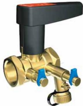
BALLOREX® V используется для балансировки систем отопления, охлаждения и обеспечивает необходимое распределение потоков в отдельных стояках и ветках. Применяется, как правило, в системах местного или центрального теплоснабжения, а также для обвязки вентиляционных и холодильных установок.
